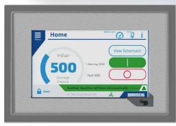
Choisir la version Plug & Play du Robox Screw ou Robox Lobe avec Robox Connect vous permet d'utiliser un seul outil pour surveiller l'ensemble du système. Robox Connect vous permet de vous connecter directement au convertisseur de fréquence pour surveiller le système et agir comme une commande d'automatisation. Le contrôleur Robox Connect est suffisant pour effectuer toute modification des paramètres ou de la logique du variateur électronique de vitesse.
