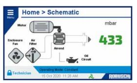
Contrôlez l'état des principaux composants de votre surpresseur à lobes ou à vis, tels que l'étage de compression, le filtre à air, le moteur électrique principal et le ventilateur du capot. Vérifiez quand il est nécessaire de remplacer les pièces consommables, effectuez les vidanges d'huile et vérifiez l'état du filtre à air et du moteur principal.
