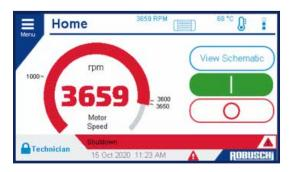
Suivez facilement les codes d'alarme! Lorsque un code d'alarme avec sa description s'affiche, il vous suffit de toucher l'alarme pour voir les informations relatives à l'alarme enclenchée. Vous pouvez également revoir les alarmes précédentes, si besoin est.
