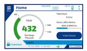
La fonction Entretien vous permet de vérifier l'état de service des filtres, de la lubrification, des courroies et d'autres composants importants afin que vous sachiez quand les remplacer. Vous pouvez également réinitialiser les notifications au remplacement de chaque composant.
