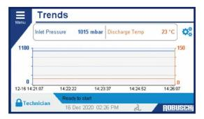
Surveillez tous les paramètres essentiels, tels que la pression d'aspiration, la pression de refoulement, la température de refoulement, le régime, la température de l'huile, etc. De même, comparez les données actuelles avec celles des 30 derniers jours. Pour une meilleure visualisation et comparaison des données, la fonction Robox Connect vous permet de télécharger les relevés sur votre appareil.
