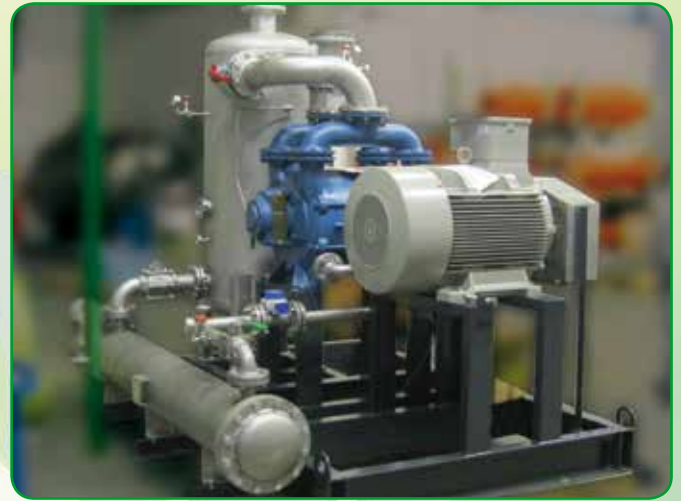
Gruppi vuoto per impianti di cogenerazione biomasse .
