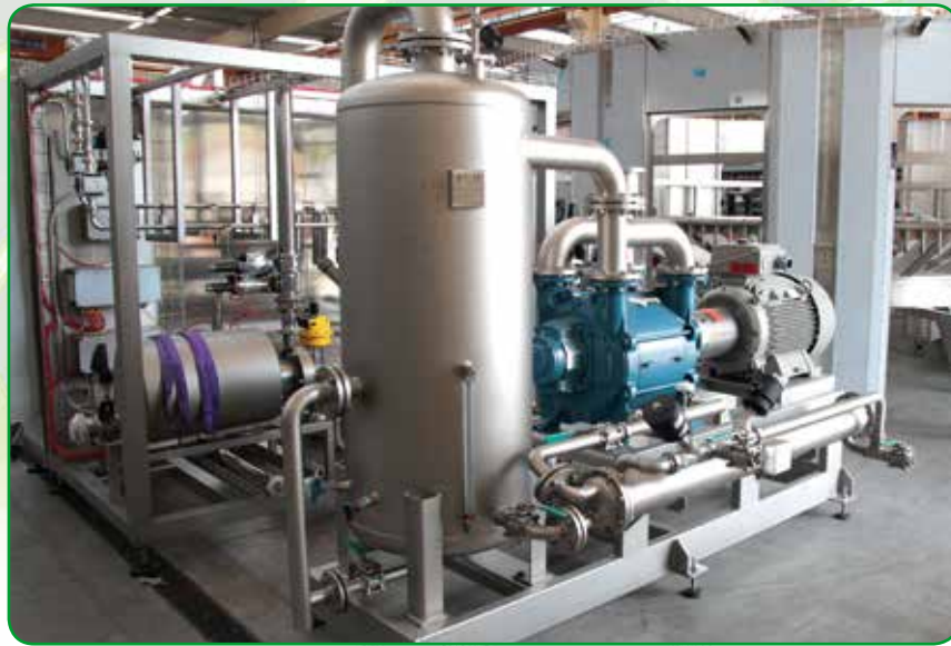
Imbottigliamento: pompe per vuoto impiegate per aspirare aria negli impianti di riempimento bottiglie in vetro.
