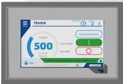
Choisir la version Plug & Play du Robox Screw ou Robox Lobe avec Robox Connect vous permet d'utiliser un seul outil pour surveiller l'ensemble du système. Robox Connect vous permet de vous connecter directement au convertisseur de fréquence pour surveiller le système et agir comme une commande d'automatisation. Le contrôleur Robox Connect est suffisant pour effectuer toute modification des paramètres ou de la logique du variateur électronique de vitesse.
